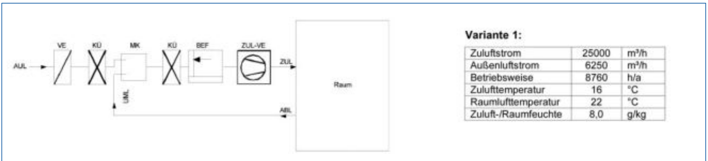
Abb. 2: Lufttechnisches Prinzipschema und wichtige Betriebsdaten der Anlage gemäß Variante 1
