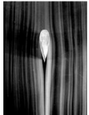
Abb. 1: Umströmung Rund- und Tropfenprofil im Windkanal [1]
