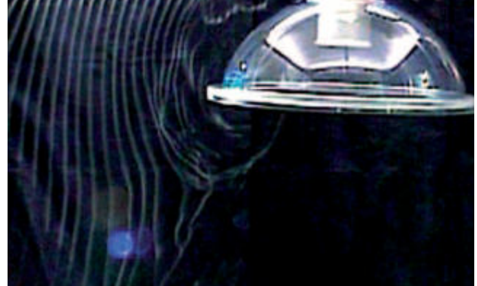
Abb. 6: Umströmung einer Absaugelocke in einem TAV-Bereich
