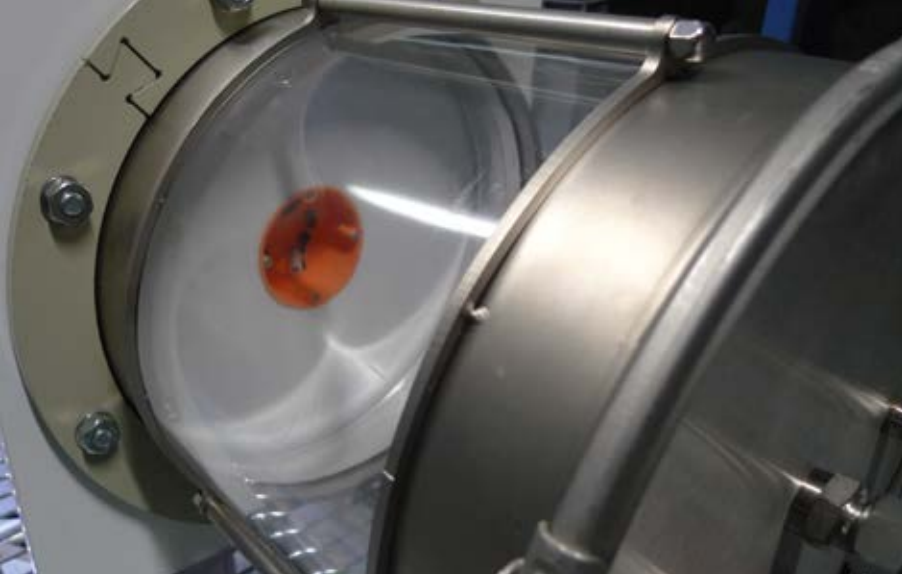
↑ Prüfstand zur Messung der Luftdurchlässigkeit
